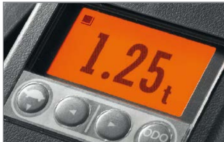
Мультифункциональный дисплей с индикатором веса груза
